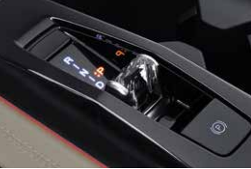
크리스털 토글타입 전자식 변속 레버 뛰어난 변속 응답성과 LED 인디케이터를 적용하여 야간 시인성 증대 및 손쉬운 조작이 가능합니다.
