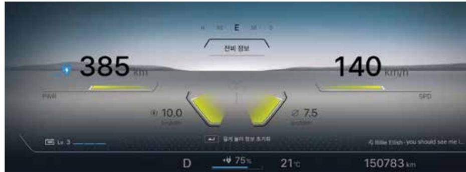
주행 상태, 차량 컨디션 등 다양한 정보를 운전자에게 제공하여 안전한 운행을 지원합니다. 또, 주야간/드라이브 모드에 따른 그래픽 변화로 운전의 즐거움을 향상시켜 줍니다.
