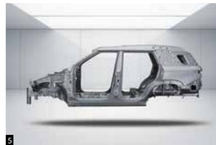
1. 8 Airbag 2. 이머전시 이스케이프 키트 3. 다중 충돌방지 시스템 (Multi Collision Brake) 4. 후진 경고음 시스템 (AVAS) 5. EV 최고 수준의 81% 고장력강
