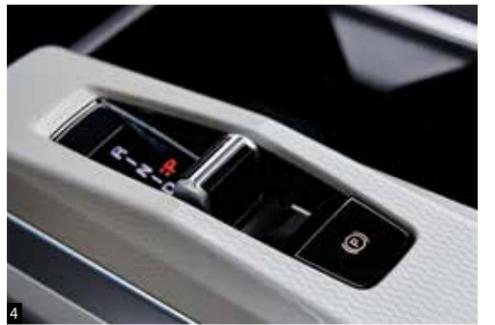
1. 파노라마 디스플레이 2. 엠비언트 라이트 3. 컨디셔닝 모드 (잠시 애완동물을 두고 내려야 할 때 에어컨이나 히터가 켜진 상태에서 차량을 잠글 수 있는 모드) 4. 토크스위치 타입 전자식 변속시스템
